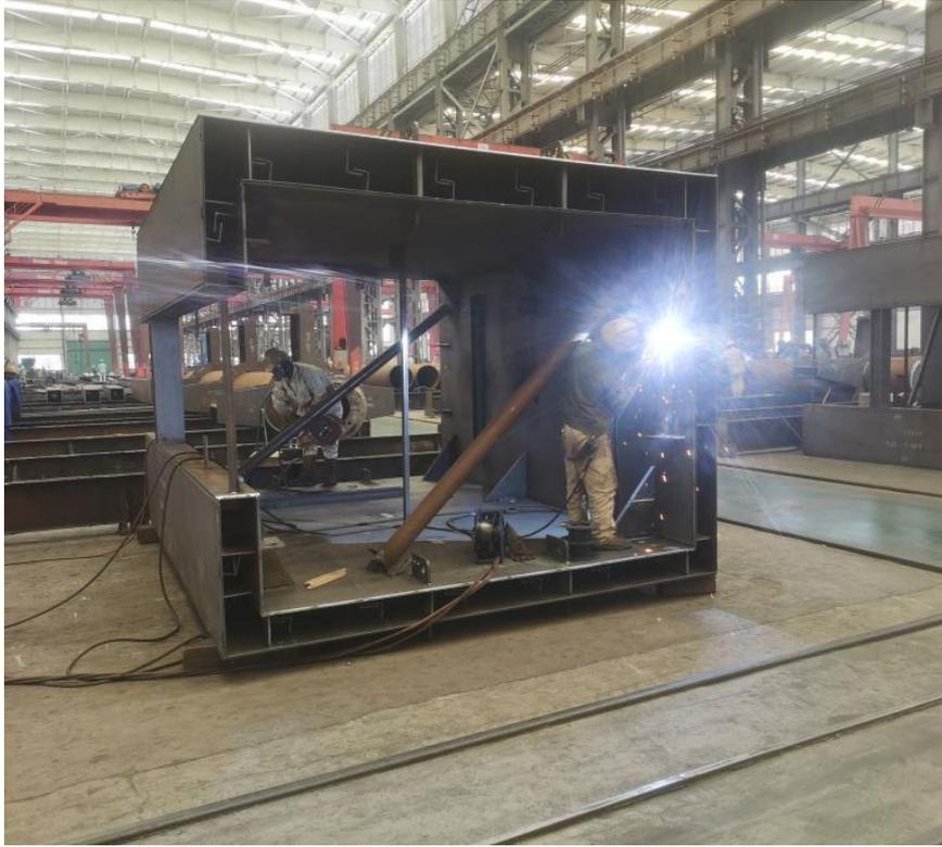
图 5 钢板剪力墙整体组焊
