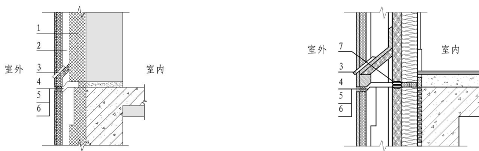
(a) 夹心保温剪力墙板竖缝导水管设置构造示意
