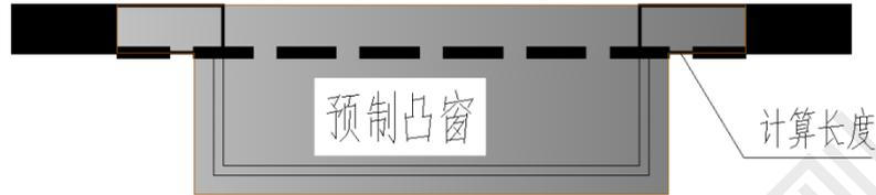
图 5.0.4-4 预制凸窗计算长度示意图
