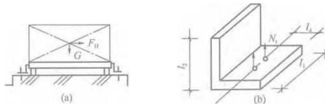
图 15 L 形抗震防滑铁件计算简图
