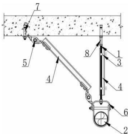
图 3 侧向抗震支吊架示意图
