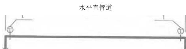
图 19 水平直管段抗震支吊架设置
