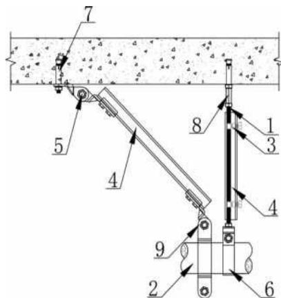
图 4 纵向抗震支吊架示意图
