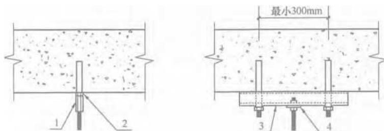
图 7 吊杆根部构造示意图（钢筋混凝土结构）
