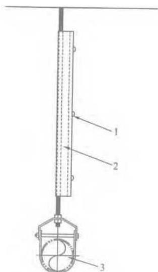
图 5 单管（杆）抗震支吊架示意图
