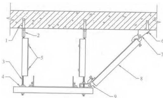
图 6 门型抗震支吊架示意图
