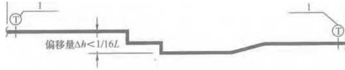
图 22 刚性连接水平管道纵向偏移示意
