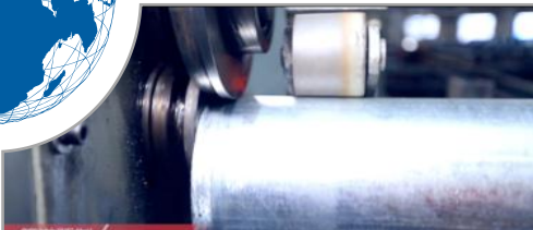
在线批量滚槽
